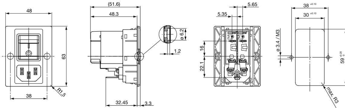
Schraubbefestigung Version B für Rückmontage IP40
