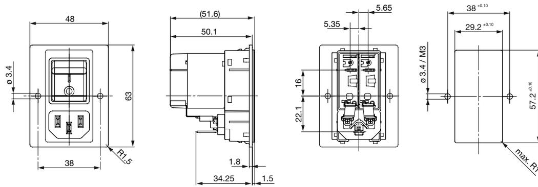
Schraubbefestigung für Frontmontage IP67
