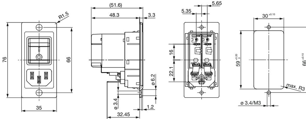
Schraubbefestigung Version A für Rückmontage IP40
