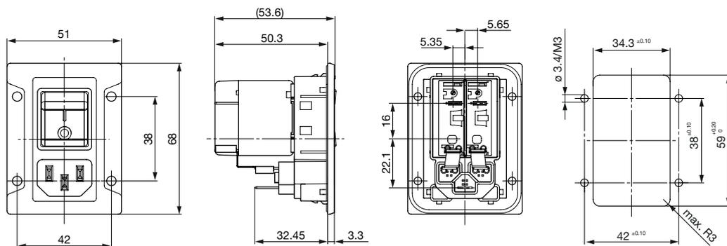
Schraubbefestigung Version A für Frontmontage IP40 mit Magnetmodul
