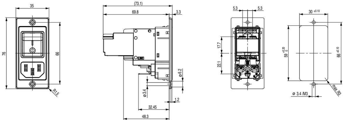
Schraubbefestigung Version B für Frontmontage IP40 mit Magnetmodul
