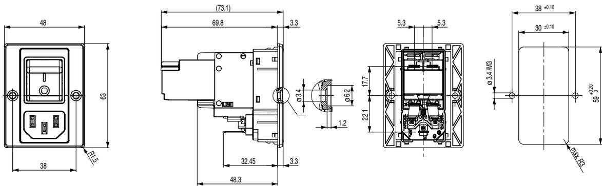
Schraubbefestigung für Frontmontage IP67 mit Magnetmodul
