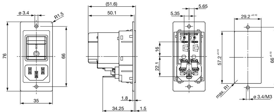
Schraubbefestigung Version B für Frontmontage IP40
