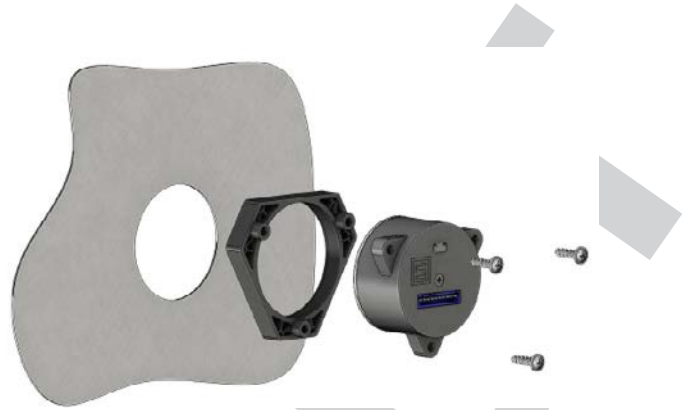
Montage des Design-In Kit mit Montagering (mit doppelseitigem Klebeband)
