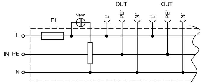
Verteilleiste mit 5 Gerätesteckdosen und Wippschalter beleuchtet
