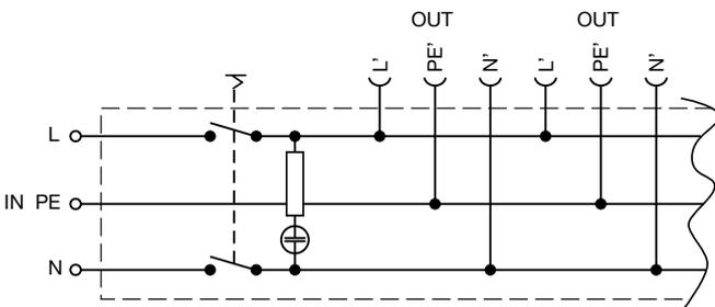
Verteilleiste mit 5 Gerätesteckdosen, Sicherungshalter, Anzeigelampe und Filter
