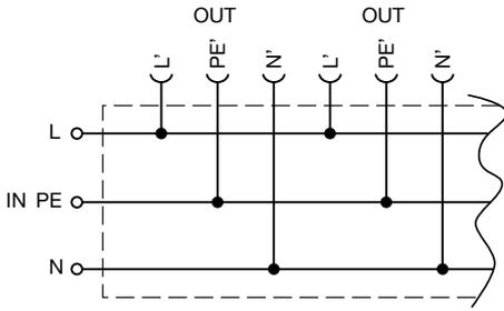
Verteilleiste mit 5 Gerätesteckdosen, Sicherungshalter und Anzeigelampe
