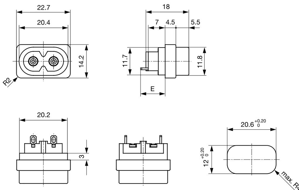
E = Lötanschluss kurz: 10.5 mm
