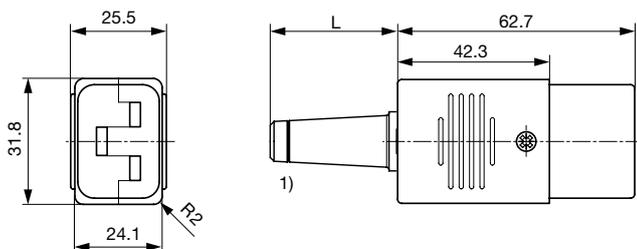
1) Die Knickschutztülle auf das entsprechende Kabel zuschneiden
